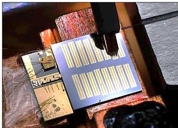
рооптический генератор частотных гребенок, который обеспечивает беспрецедентное спектральный охват 450 нм с более чем 2000 линиями спектра. Это позволило расширить пропускную способность устройства и почти в 20 раз снизить потребляемую мощность микроволн по сравнению с предыдущими разработками.
