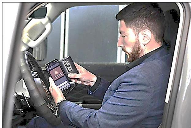
В основе работы устройства лежит та же технология оптической спектроскопии, что и в алкорамках. Для проверки водитель должен выдохнуть в прибор, который установлен в автомобиле (а личность водителя идентифицируется через мобильное приложение). Если содержание алкоголя превысит допустимый порог, «Алкозамок-Смарт» просто не позволит завести двигатель.
