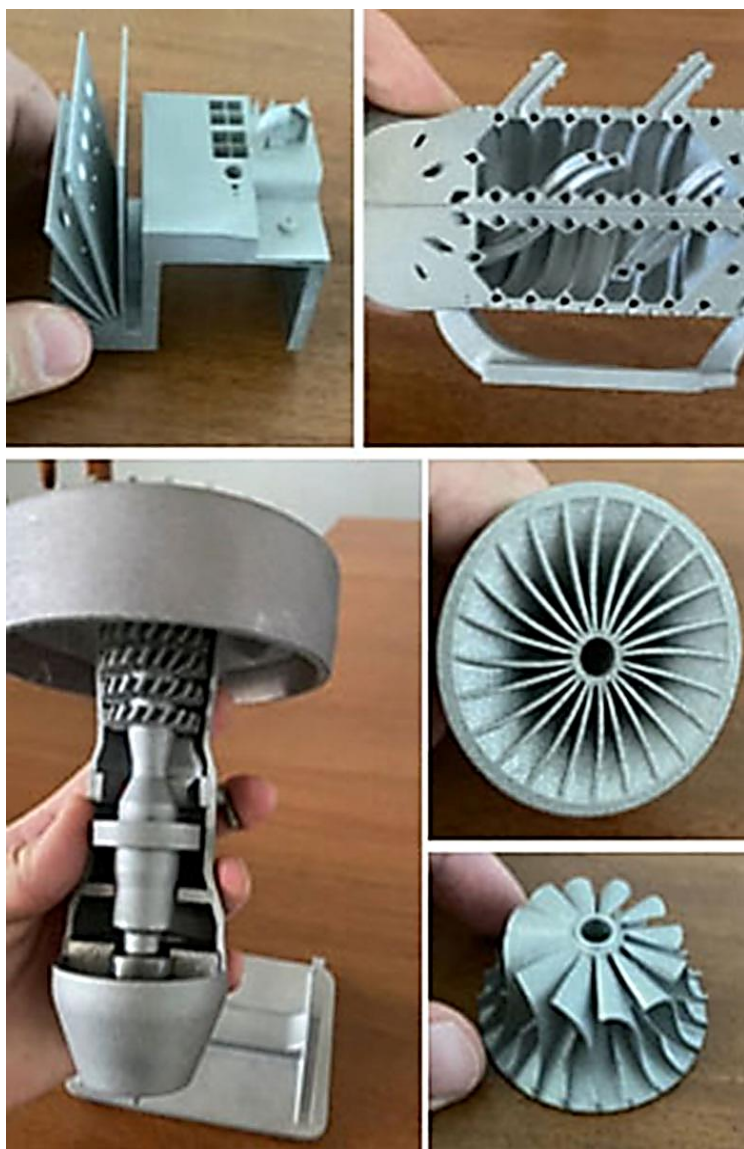
Рис.5 Фотографии деталей и узлов, полученных аддитивным выращиванием из различных порошковых материалов.
