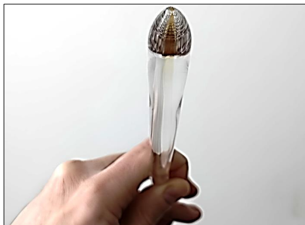
Кварцевая преформа с сердцевинной, легированной висмутом.
