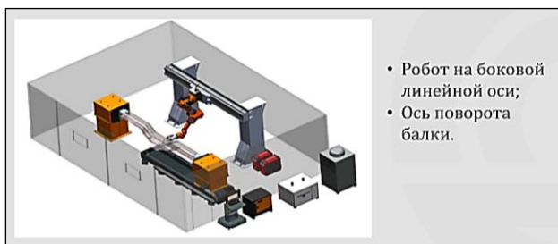
Рис.4 Схема расположения оборудования для роботизированной лазерной гибридной сварки балок рам тележки.
