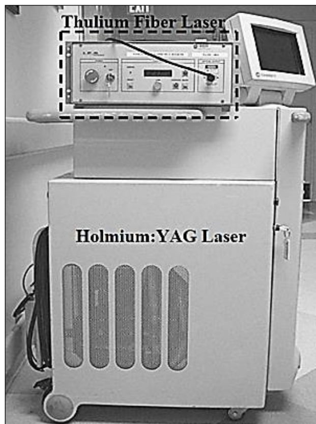
Рис.1 Сравнение размеров аппаратов для урологии на основе тулиевого волоконного лазера и на основе Ho:АИГ.
