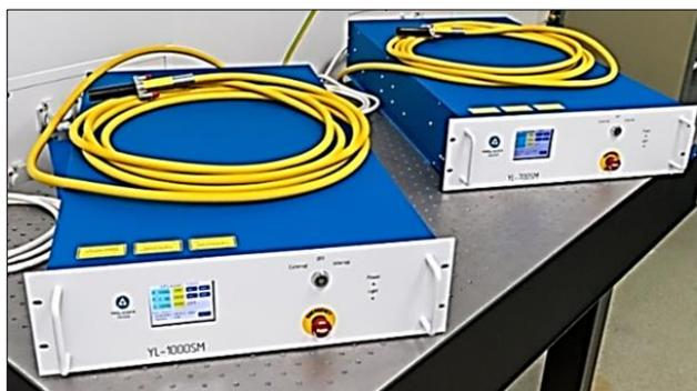
**Рис.1** Одномодовые волоконные лазеры мощностью 700 и 1000 Вт разработки ФГУП «РФЯЦ – ВНИИТФ им. академ. Е.И.Забабихина».
