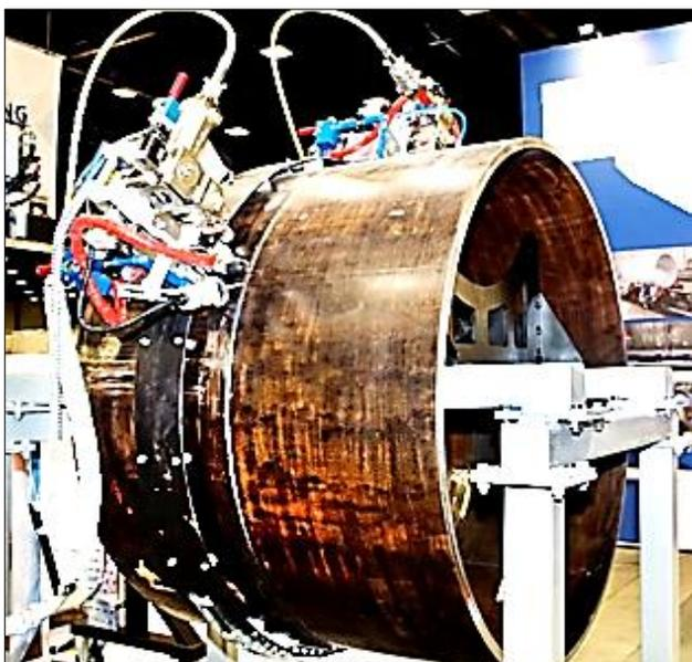
Рис.2 Фотография орбитальной лазерной сварки трубопровода двумя оптическими сварочными головками.
