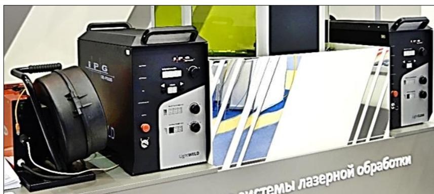
**Рис.9** Системы LightWELD и LightCLEAN.
