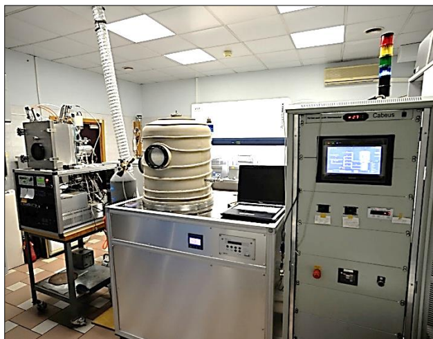
Рис.3 Вакуумное нанотехнологическое оборудование Центра акустооптики МИСИС для изготовления пьезопреобразователей акустооптических устройств
