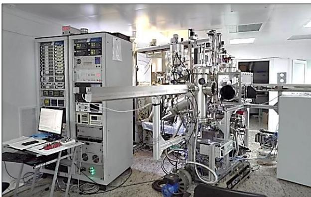
*Ростовой реактор для изготовления новых типов полупроводников был запущен в Беларуси в 2017 году.*
