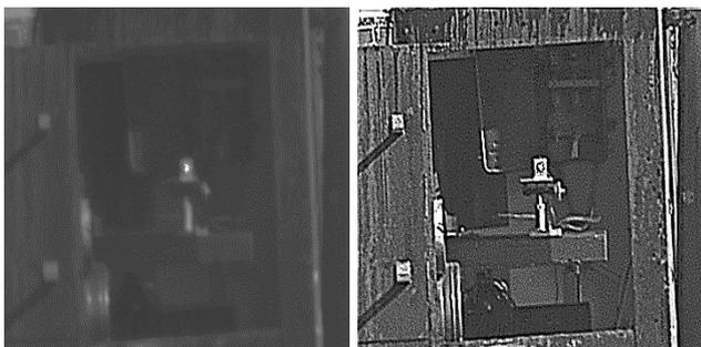
**Рис.5** Пример коррекции экспозиции и турбулентного размытия видеокadres методом рекурсивного накопления и обратной фильтрации на горизонтальной трассе 450м полигона ИОА СО РАН. Условия наблюдения: сумерки, умеренная турбулентность, параметр  $D/r_0 \sim 7$ .
