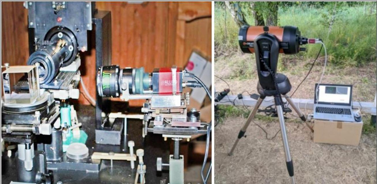
**Рис.1** Анализатор качества цифровых изображений (слева) в схеме адаптивной оптики на БСВТ Байкальской астрофизической обсерватории ИСЗФ СО РАН и мобильная система наблюдения и анализа изображений с измерением параметров атмосферной турбулентности (справа).
