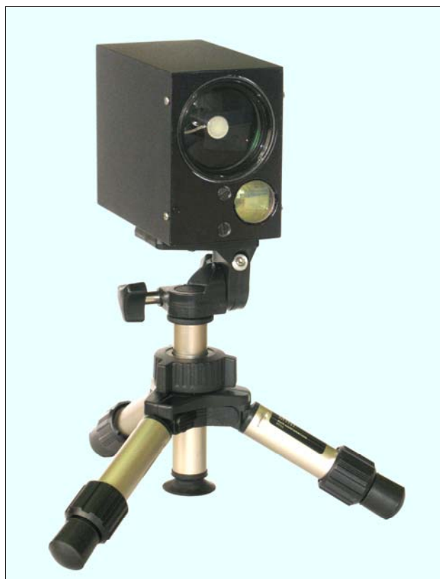
@Рис.4 Внешний вид дальномерного модуля, установленного на фотоштативе.
