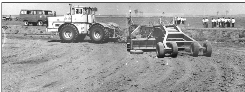
Рис.1 Эксплуатационная планировка рисовых чеков планировщиком Д-719 с лазерным контролем плоскости чека.
